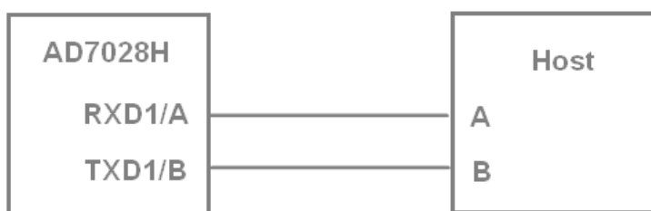
RS485 接口（可选）电路连接示意图
